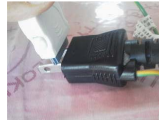
コンセントに差し込んだ状態で2本のプラグを接触
