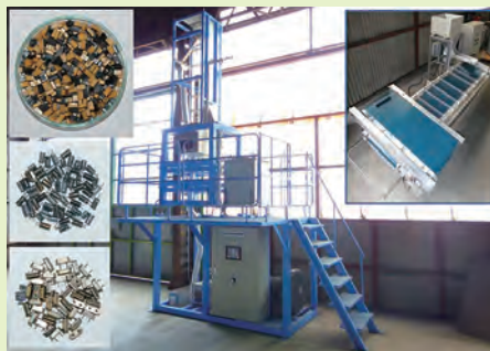
レアメタルを高純度に回収する複管式気流選別機
