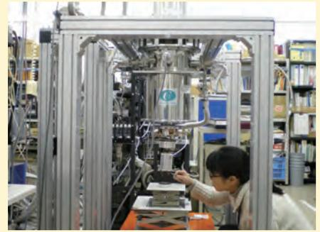
断熱型熱量計での作業の様子
