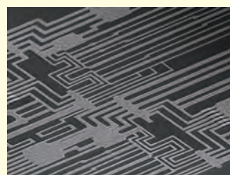
微細加工した単層CNT銅複合材料
