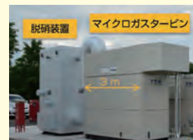
試作した発電装置
