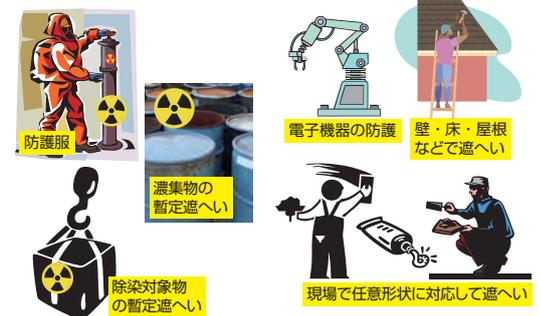
図2 固化した素材を防護物に加工したり、固化前の素材を現場で任意形状の物体に塗布するなどの利用が想定される。
