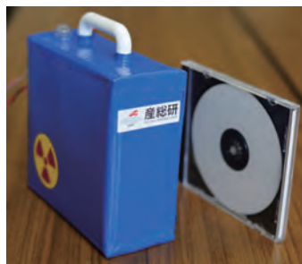
図1 パルスX線源(120 kV)とサイズ比較のためのCDケース(左)と金属製バルブのX線透過写真(中央:バルブ閉、右:バルブ開)
