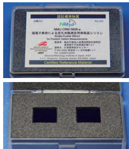
図2 陽電子寿命による空孔欠陥測定用単結晶シリコン(NMIJ CRM 5606a) [2]
