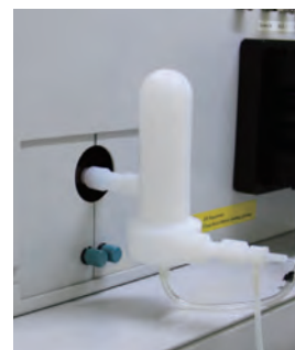
図2 高精度同位体比測定用耐ふっ化水素酸試料導入系 鉛フリーはんだをふっ化水素酸-硝酸の混合酸で分解した溶液はとて安定であるが、質量分析装置へ直接導入できないため、耐ふっ化水素酸の試料導入系に改良。
