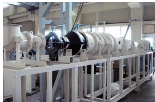
図2 実用標準として用いられるエッフェル型風洞
