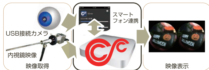
図1 ソフトウェア開発キット SCCToolKit を用いたシステム構成例
