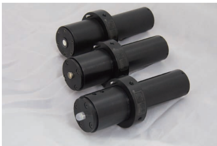
図2 LEDの明るさ評価の基準となる標準LED（明るさ・色・測定量に応じてさまざまな種類の標準LEDを開発）
