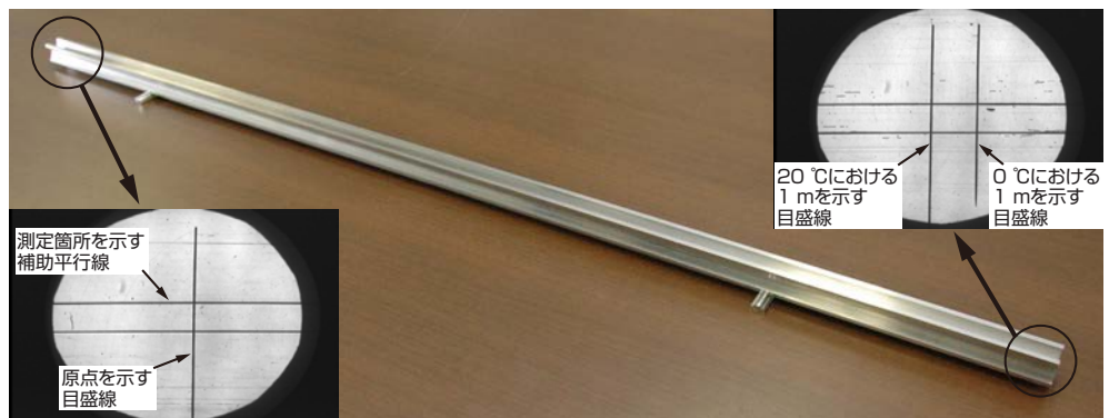
メートル原器と原点目盛線(左下)、20℃における1 mを示す目盛線、0℃における1 mを示す目盛線(右上)
