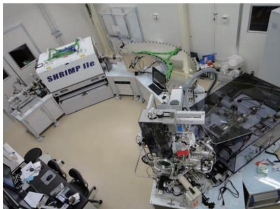
写真1 高精度年代測定装置 SHRIMP IIe (豪州 ASI 社製)
