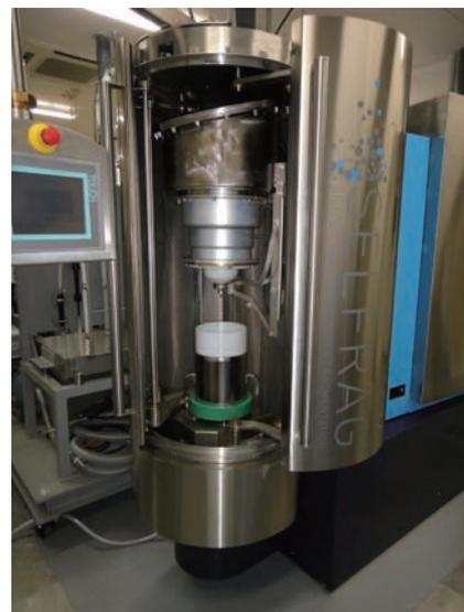
写真2 高電圧パルス岩石粉砕装置 SELFRAG LAB(スイス SELFRAG AG 社製)
