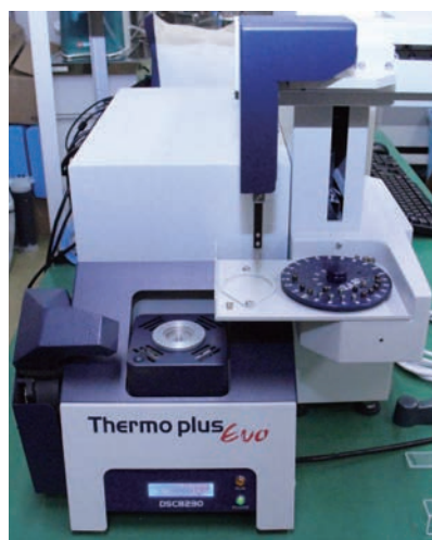
示差走査熱量計 (DSC) 装置と測定例
