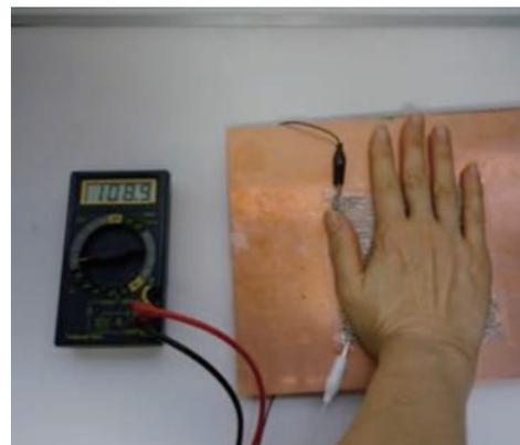
印刷法により作製したフレキシブル熱電変換フィルム (左) とその発電能力 (右)
