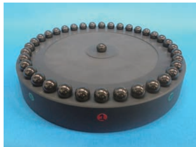
図1 ピッチ測定精度評価用球基準器
