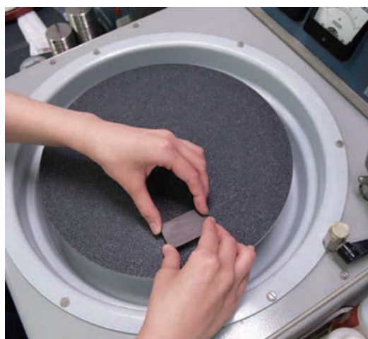
図1 乾式で岩石試料を研磨する様子
