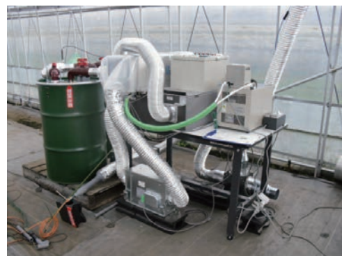
図2 CO 2 供給試作実証機
