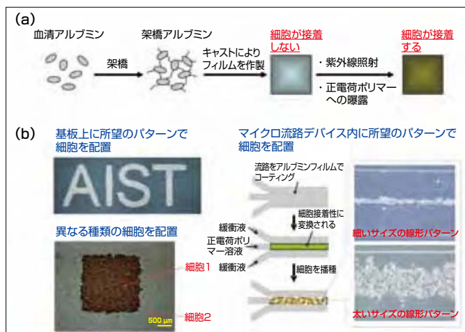
図3 (a) 細胞接着性を制御できるアルブミンフィルム。(b) アルブミンフィルムを利用した細胞パターンニング。
