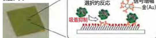
図1 バイオセンサーに用いる検出チップ。表面に抗体を固定することでターゲットとなる物質に選択的に結合する。
