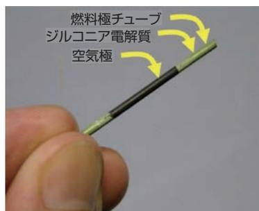
図1 チューブ型マイクロSOFC (1 W出力)
