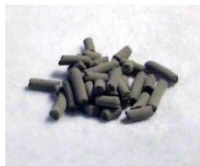
成型後の触媒の写真 (太さ約5 mm)
