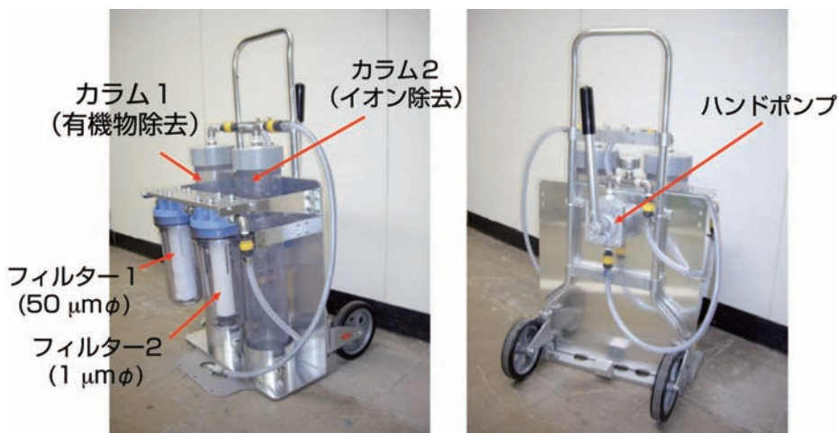
図2 機動的浄水システムの試作品
