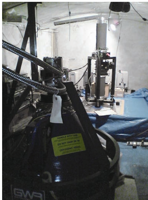
名古屋大学 犬山観測所の地震観測壕内におけるSG(手前)、FG5(中)、CG3M(奥3台)の並行観測の様子
