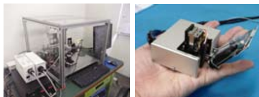
写真1 左：現在市販されているスーパーインクジェット装置 右：今回開発した手のひらサイズのスーパーインクジェット装置
