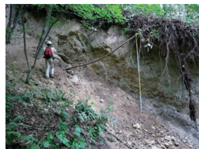
地震により荒砥 あらと 沢ダム北方の尾根に出現した崖。ここでは向側の地盤が相対的に上に約4 m、右に4 m以上動いていることが確認された。
