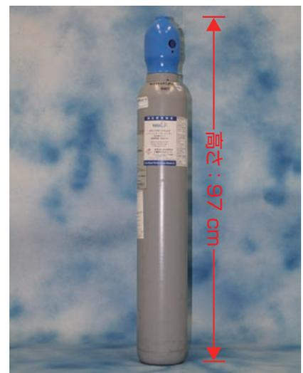
CF<sub>4</sub>、C<sub>2</sub>F<sub>6</sub> 濃度標準ガス (NMIJ CRM 4405-a)
