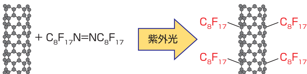
カーボンナノチューブのフッ素官能基化学修飾反応
