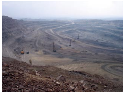
写真1 中国バヤンオボ：世界最大の希土類鉱山。鉱石埋蔵量は鉱量約5,700万t、酸化希土類品位6%。
