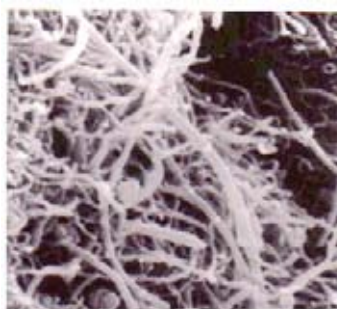
分解により副生した炭素のSEMイメージ
