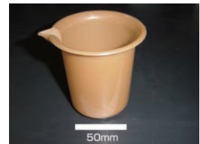
図2 セルロース-ポリエチレン系ポリマーアロイからの射出成形品
