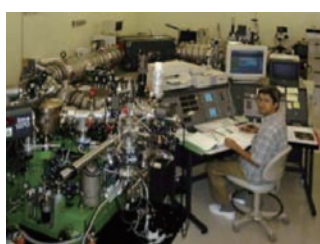
図3 石英斑晶中のガラス包有物(写真:左) ガラス包有物(赤矢印)は斑晶の容器に包まれているため、噴火時の減圧や脱ガスを免れる。マグマの飽和含水量には圧力依存性があるので、噴火前の含水量を二次イオン質量分析計(写真:上)で分析すればマグマ溜まりの深さが推定できる。
