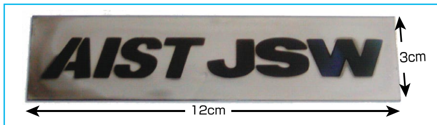
図5 このプロセスにより作製した超電導薄膜 (3 cm × 12 cm サイズ基板。 黒色のパターニング部のみ超電導性を示す。)
