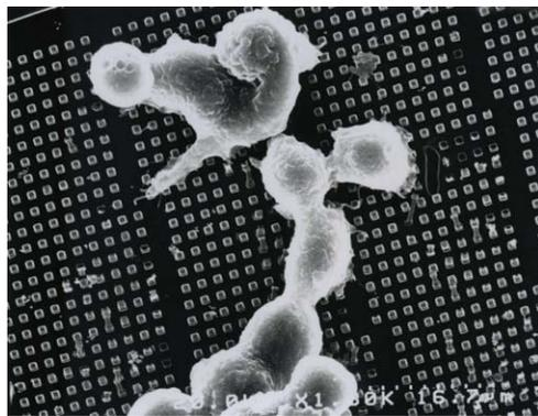
図1 ナノインプリント技術によるナノピラーシートの作製法(左)とナノピラー(径0.5 μm)上で培養したHeLa細胞の電子顕微鏡写真(右)
