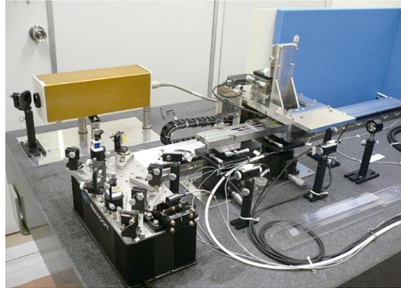
写真3 デジタルスケール校正装置
