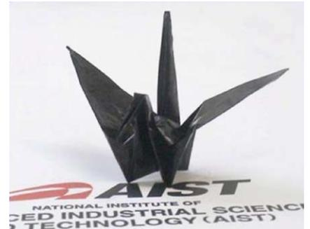
写真1 高品質SWNTシートで作製した折り鶴
