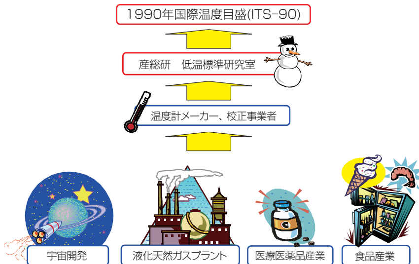
図1 低温度領域での温度目盛のトレーサビリティの模式図 図中では低温度を利用している産業の例を示している。
