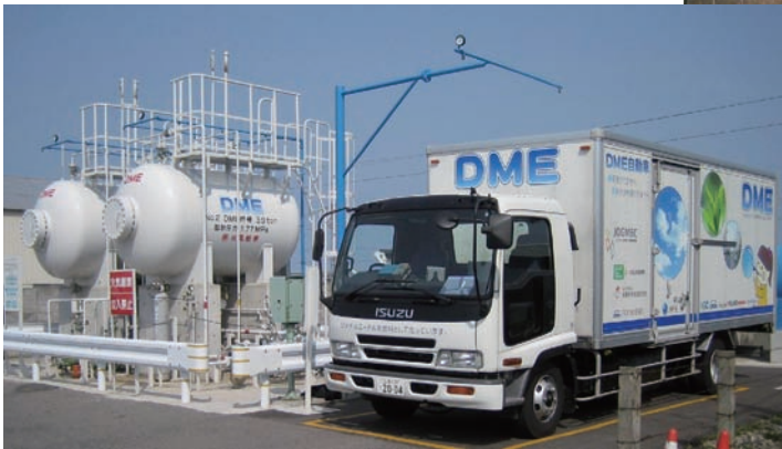
写真2 DMEトラック(産総研)と DME充填システム(三菱ガス化学)
