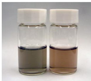
図4 (左)はSWCNTを分散した溶液、(右)はβカロテン内包SWCNTを分散した溶液。内包されているβカロテンの存在によってほかに赤みを帯びていることが分かる。
