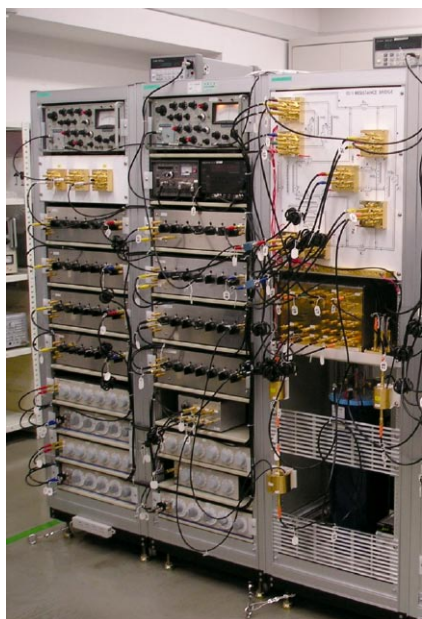
写真1 交流抵抗測定装置 交流抵抗標準の起点となる装置であり、計量法における特定標準器に指定されている。基準交流抵抗器の値付けに用いる。
