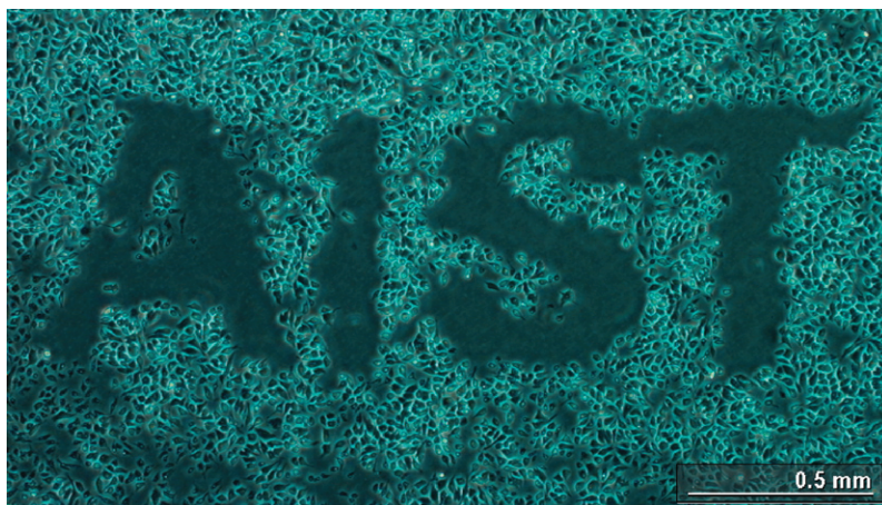
図3 一様播種・培養後の局所光照射によって一部の細胞が抜き出された基材表面
