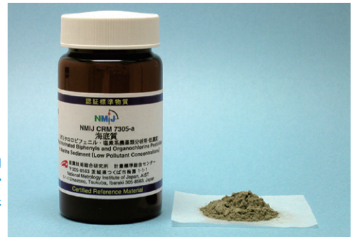
図2 海底質標準物質 NMIJ CRM 7305-a (ポリクロロビフェニル・有機塩素系農薬類分析用-低濃度)
