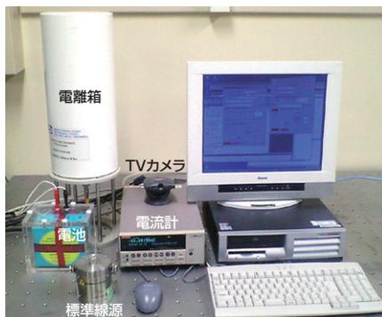
図3 遠隔校正システムの構成
