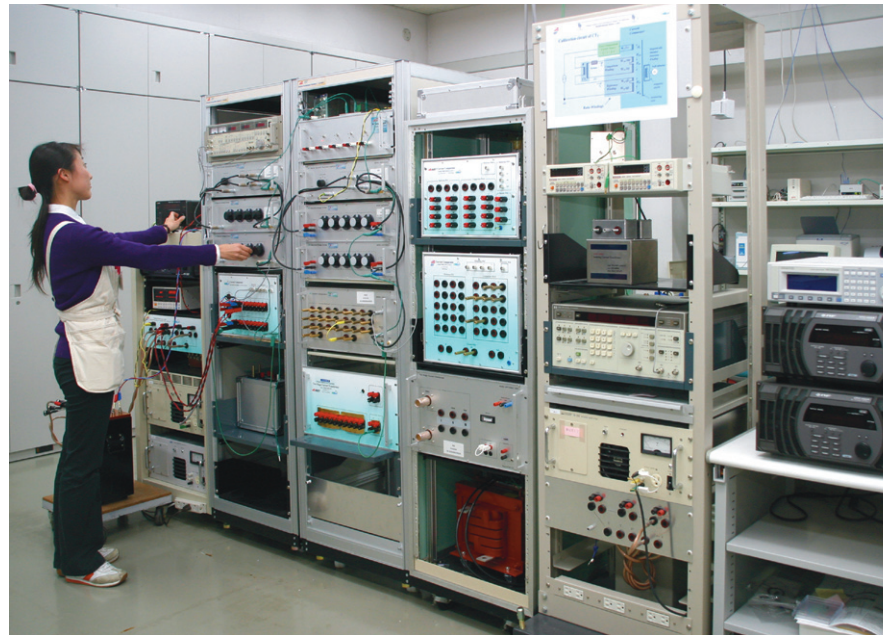
写真 誤差補償変流器（被試験変流器）を試験中の交流電流比標準システム
