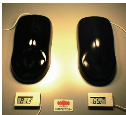
図2 模型による表面温度の比較
