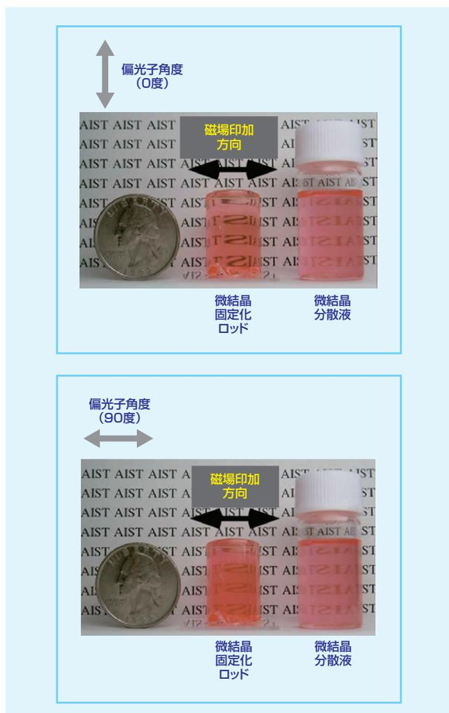
図8 バルク異方性材料の偏光子を介した写真
