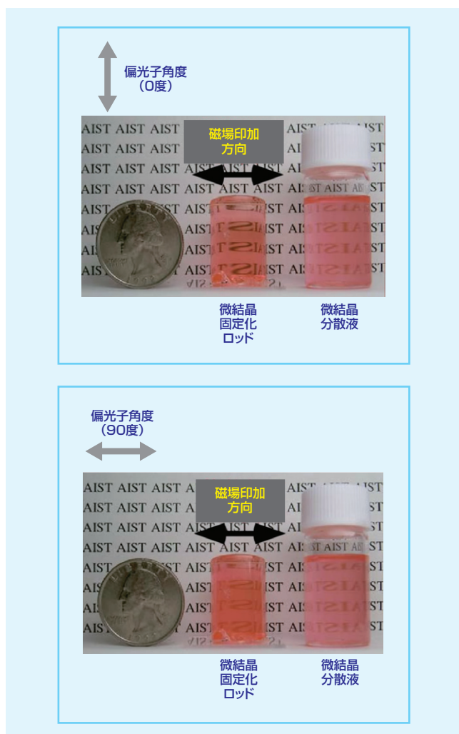
図8 バルク異方性材料の偏光子を介した写真 (上) 印加磁場と平行に偏光子をおいた場合 (下) 印加磁場と垂直に偏光子をおいた場合
