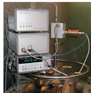
写真2 プログラマブル型ジョセフソン電圧標準素子を用いて行われる、高精度のファスト・リバースDC測定。
