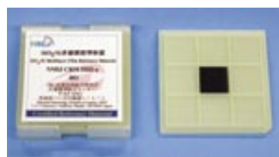
写真 深さ方向分析の測定条件の調整に用いることが可能なSiO 2 /Si多層膜標準物質
