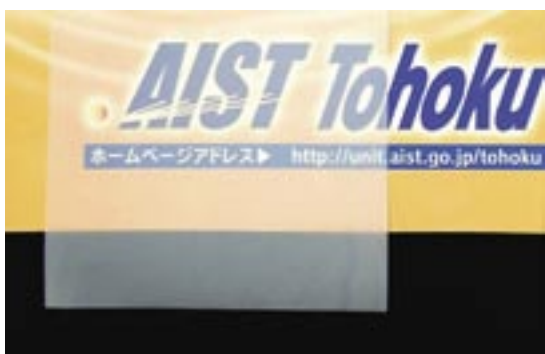
半透明ガスバリア膜の外観写真 (寸法:幅10cm×長さ10cm)
