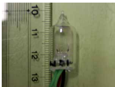
写真 真空熱電対型交直変換器
