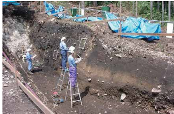
●トレンチ調査(栃木県の関谷断層) 断層を横切るような溝を掘削し、壁面を観察・分析することによって、断層の活動時期等を明らかにしています。
