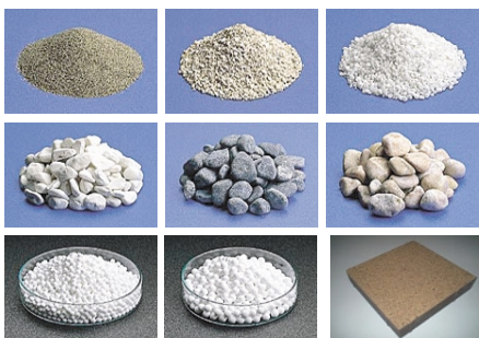
図2 酸化チタンの表面を備えた多機能の複合材料と透水性ブロック(右下)
