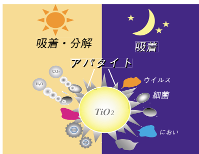
図1 アパタイト被覆光触媒による殺菌・環境浄化
